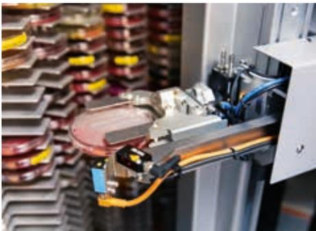
大型实验室需要压缩空气执行各种任务。例如，在这里，压缩空气负责皮氏培养皿的自动化操作...
